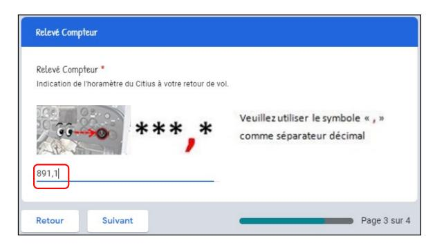
Remarque: L'horamètre de la machine Club pendulaire est quelque peu différent dans son format, à savoir qu'il est divisé en minutes, plutôt qu'en dixièmes d'heure comme dans le cas de la machine multiaxe.
